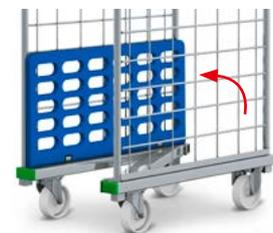
**Équipement de série :** châssis en forme de Z avec cadre en tube carré et capuchons pour profilés verts (à l'avant) et rouges (à l'arrière) Deux parois latérales avec cadre en tube rond et grille en fil. Plateau inférieur rabattable en tôle ou en plastique de couleur bleu de sécurité RAL 5005. Avec 2 sangles de serrage textiles incluses.
